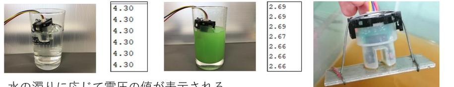
水の濁りに応じて電圧の値が表示される
