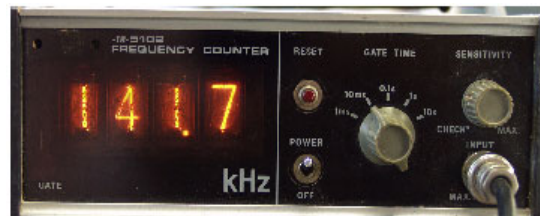
図3 アンテナに手を接触させた時の周波数測定器の写真
